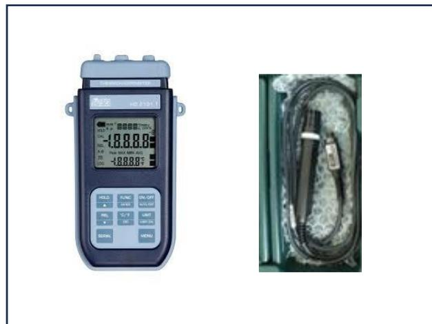
Figura 2. Patrón viajero usado en la comparación Tac-24 para participantes con cámara climática.
